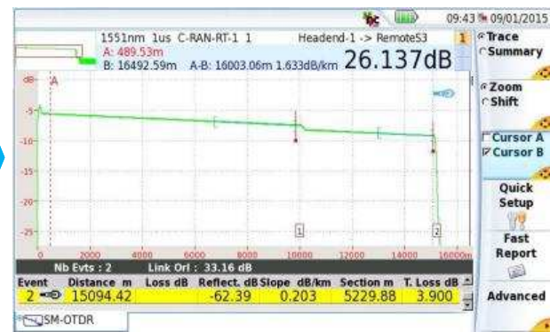
1551nm Messung über Mux / Demux in Gegenwart anderer belegter Kanäle
